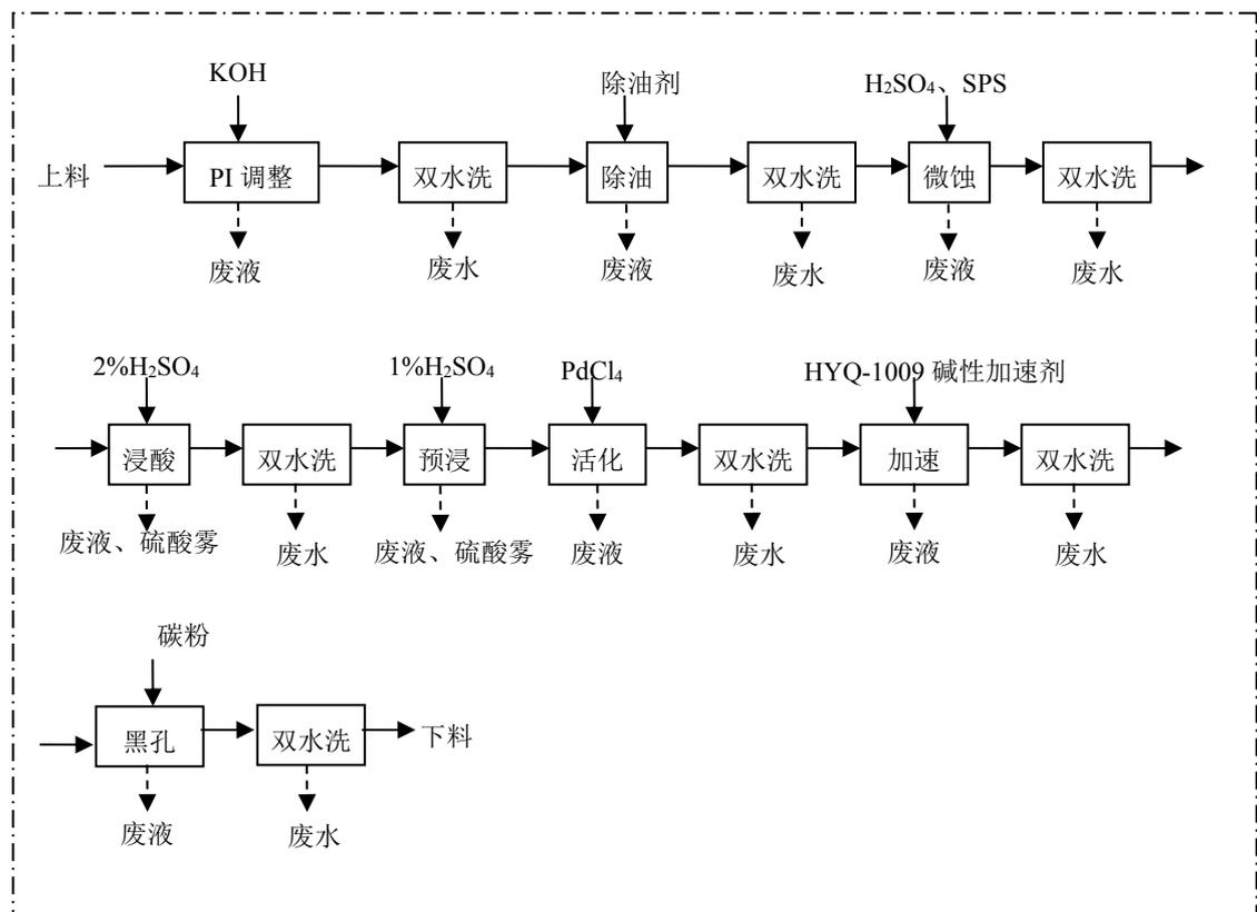
图 3-3 PTH (黑孔) 环节工艺流程及产污环节
