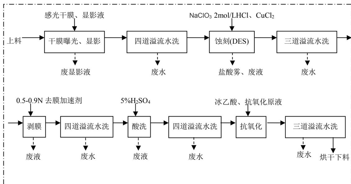
图 3-2 蚀刻环节工艺流程及产污环节
