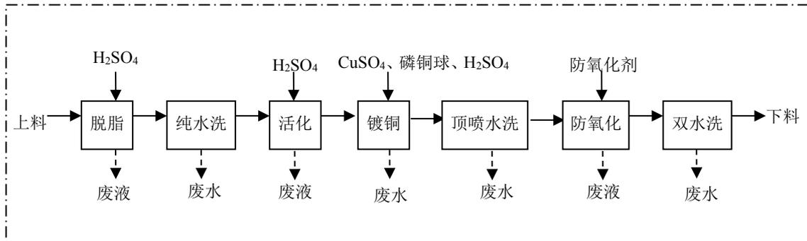
图 3-4 精密镀铜环节工艺流程及产污环节
