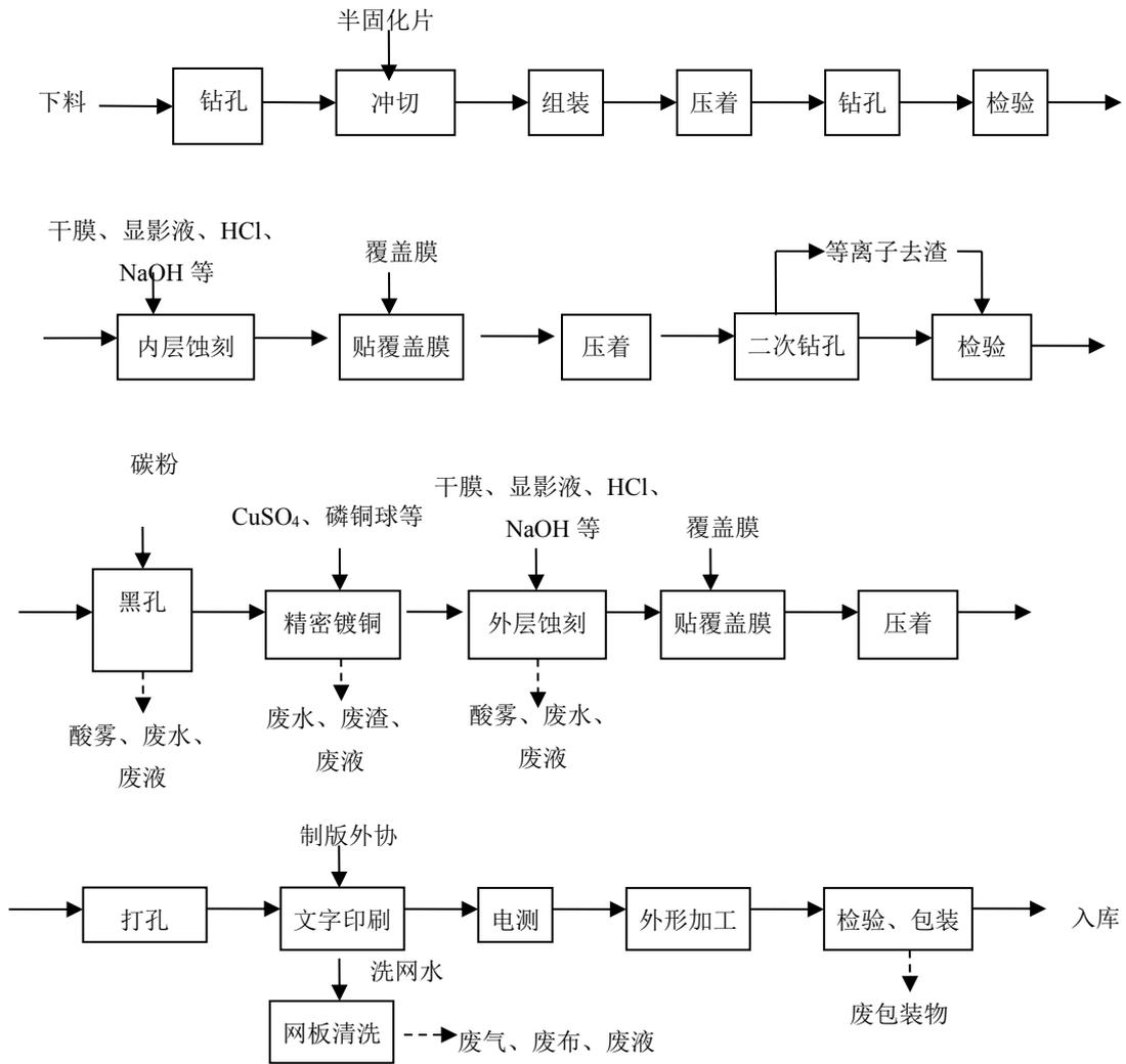
图 3-1 翔岳厂印制绕性线路板总体流程图
